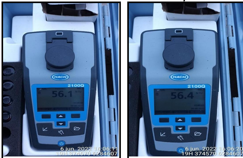
Fotografía N° 8 Medición de Turbiedad Punto 3: Compuerta 3
