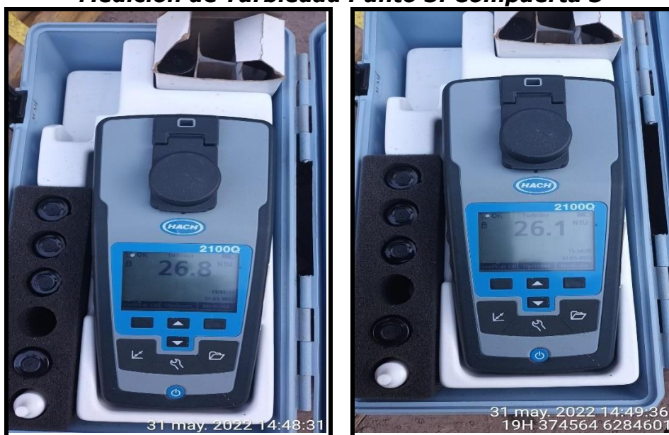
Fotografía N° 7 Medición de Turbiedad Punto 3: Compuerta 3
